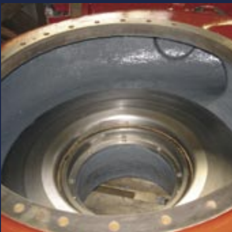
Regeneriertes Spiralgehäuse einer Kreiselpumpe
