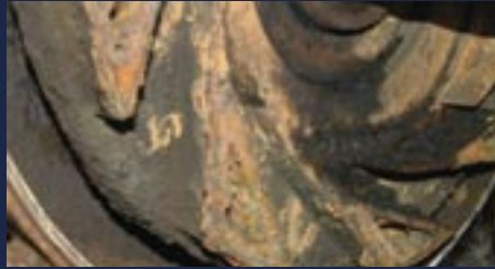
Korrosion am Laufrad einer Tauchmotorpumpe
