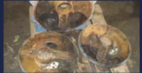
Korrosionsschaden an Vakuumpumpe
