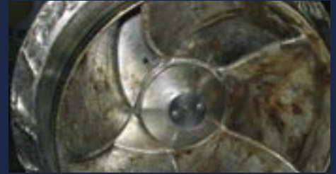
Erosionskorrosion an Edelstahllaufrad
