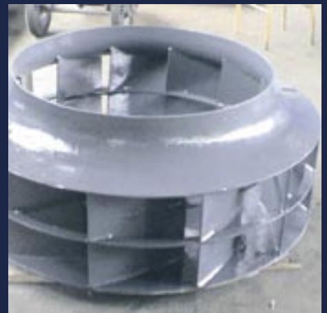
Vorbeugende Beschichtung an Lüfterrad
