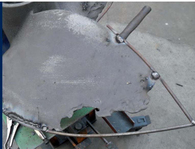
1. Flügel versehen mit Passform zum Wiederaufbau
