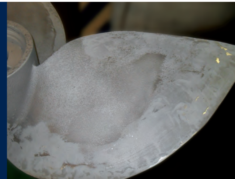
3. Nachbildung mit Epoxid auf Titanbasis und sandgestrahlt
